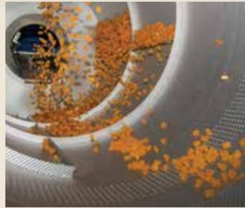
После «усыхания» масса попадает в распределительный бункер, где идет ее разделка. Здесь будущий мармелад приобретает вкус и цвет. Затем полуфабрикат идет на узел резки, откуда выходят апельсиновые и лимонные дольки, груши, улиточки, разноцветные зайки и другие.
